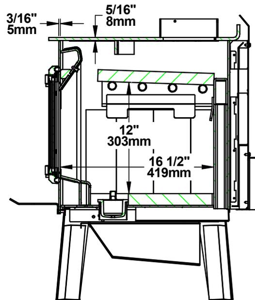
Figure 12: Vue de côté - chambre à combustion
