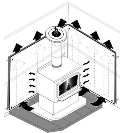
**Attention: pour réduire les dégagements d'un appareil utilisant un tuyau à paroi simple, l'utilisation d'un écran pare-chaleur certifié avec le tuyau à paroi simple à 6" des matériaux combustibles doit être utilisée. Seulement dans ce cas, les mêmes dégagements qu'avec un tuyau double certifié peuvent être utilisés. Se référer au livret présent dans les options des écrans pour obtenir les dimensions à respecter.**
