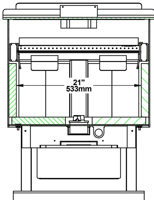
Figure 8: Vue de face - chambre à combustion
