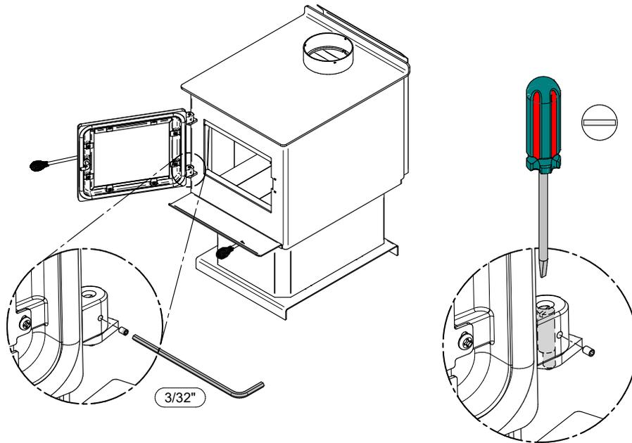
À l'aide d'un tournevis plat, tourner les tiges de pentures ajustables dans les sens indiqués pour ajuster les portes. Resserrez toutes les vis de pression sur les gonds de portes lorsque ces dernières sont aux positions désirées. Les configurations 1-2-3-4-5-6, indiquent dans quel direction celles-ci agissent sur l'ajustement de la porte.
